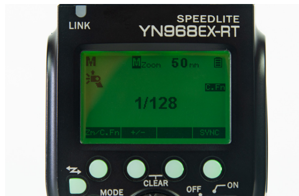
● La M representa que estamos trabajando en modo manual y la fracción 1/128 indica la potencia del destello del flash, siendo en este caso la mínima potencia.
