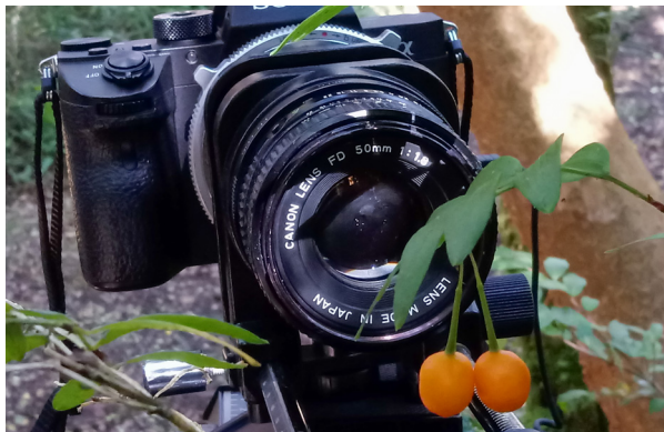
● Cámara con lente de 50mm acoplada un fuelle macro, que permite que la distancia mínima de enfoque se reduzca.
