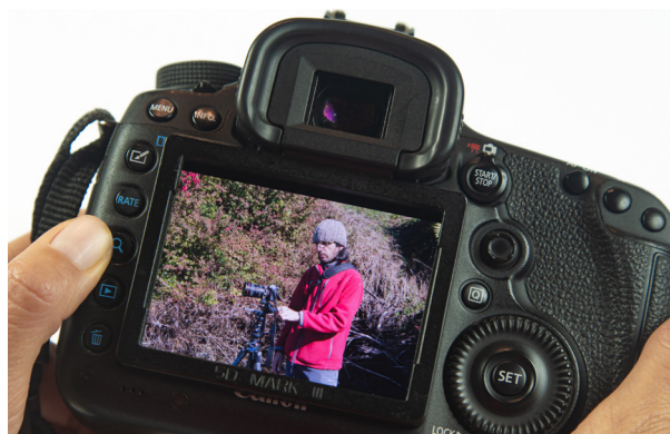
● Botones para acercar/alejar la imagen y poder ver detalles de la escena y ajustar foco.
