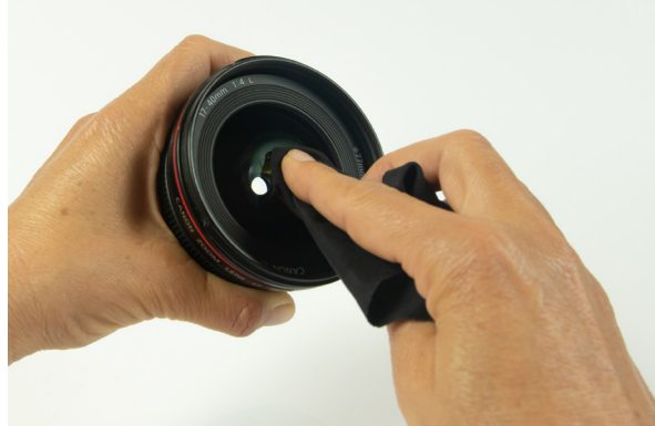
● Aplicando paño microfibra sobre la lente frontal de la lente.
