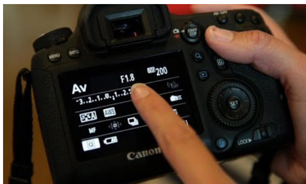
● Ajuste de diafragma en el cuerpo de cámara para lentes automáticas.
