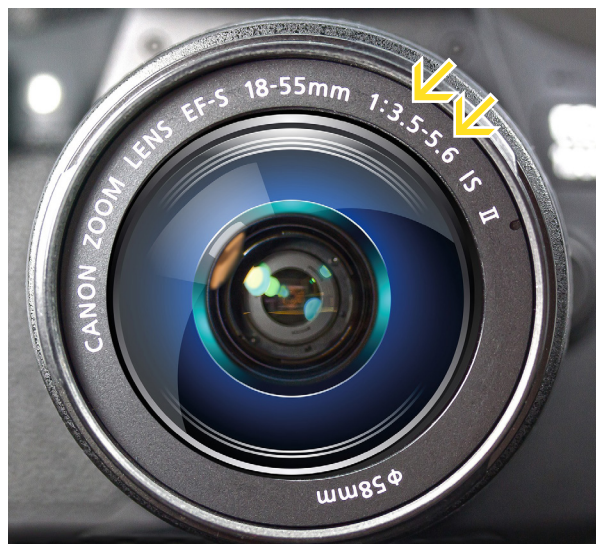
● En el caso de esta lente zoom (18-55mm) cuando se selecciona la distancia focal de 18mm la apertura máxima del diafragma es de f/3.5, y cuando se selecciona la de 55mm, es de f/5.6, con lo que en 55mm es menos luminosa que en 18mm.
