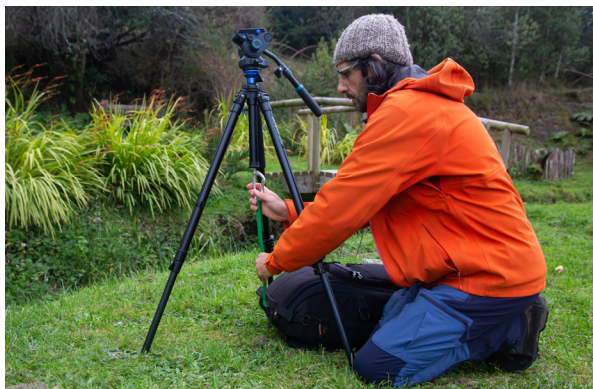
● Una forma de estabilizar el trípode es añadiendo una pesa. En este caso la propia mochila del material fotográfico hace de contrapeso, colocada en la barra central a través de un gancho.
