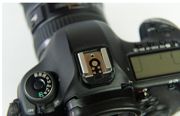
● Zapata de flash. El contacto central es el que hace la sincronía, activando el destello del flash cuando se dispara la cámara.
