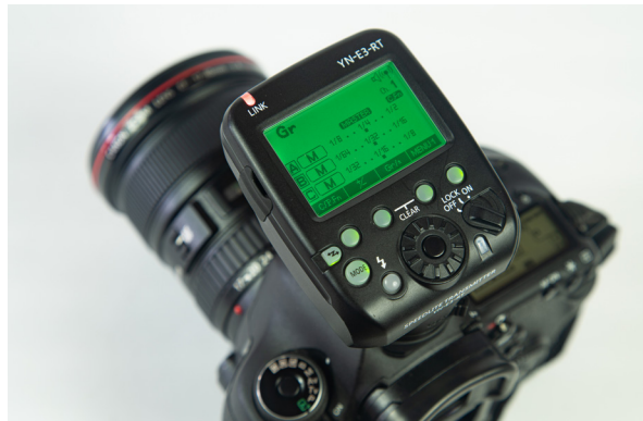
● Emisor de radiofrecuencia, llamado trigger, incorporado en la cámara para controlar los flashes de forma inalámbrica. Desde este sistema se pueden controlar varios flashes y realizar ajustes, como cambiar la potencia de cada unidad de forma independiente.
