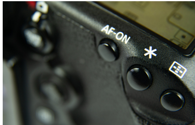
● Botón de bloqueo de exposición en una cámara Canon (*).
